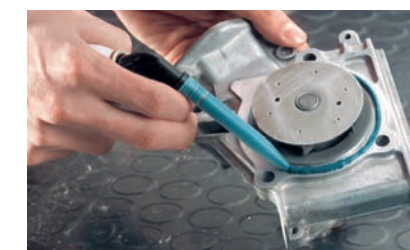
Proiect: Etanșarea pompei cu silicon
